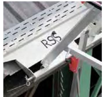
Il parapetto **Roof Safety System** è un prodotto innovativo nel campo dei sistemi di protezione collettiva. Interamente in alluminio, è certificato secondo la normativa europea UNI EN 13374 classe C, che permette un utilizzo su coperture fino a 60° di pendenza. È composto da una ringhiera da 3 metri di lunghezza, mensole e una tavola fermapiède, quindi non necessita di tavole aggiuntive.
